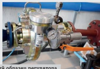
Опытный образец регулятора давления газа РГП-50
