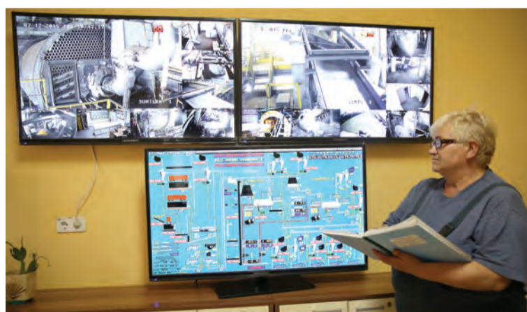
Специалист ТБЗ «Сергеевичское» фиксирует показания с автоматизированного пульта управления технологическим процессом производства топливных брикетов
