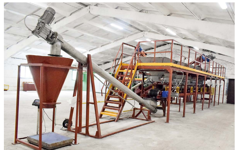
Пилотная установка по производству комплексных гранулированных удобрений пролонгированного действия. Экспериментальная база «Свислочь» НАН Беларуси
