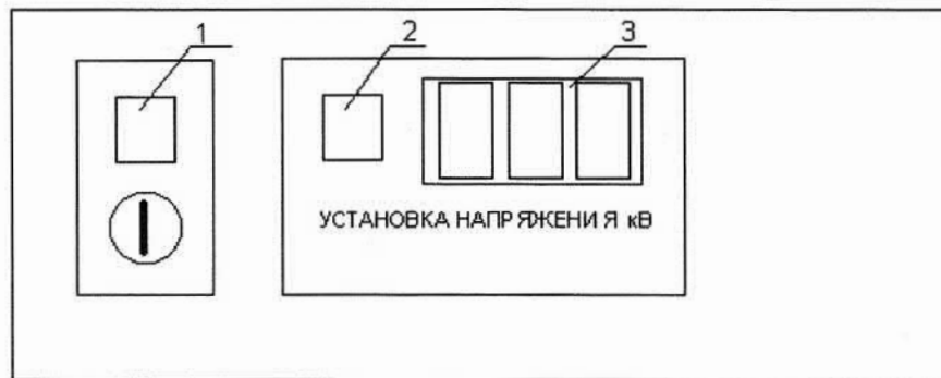
1-кнопка включения, 2-кнопка установки напряжения, 3-индикатор
