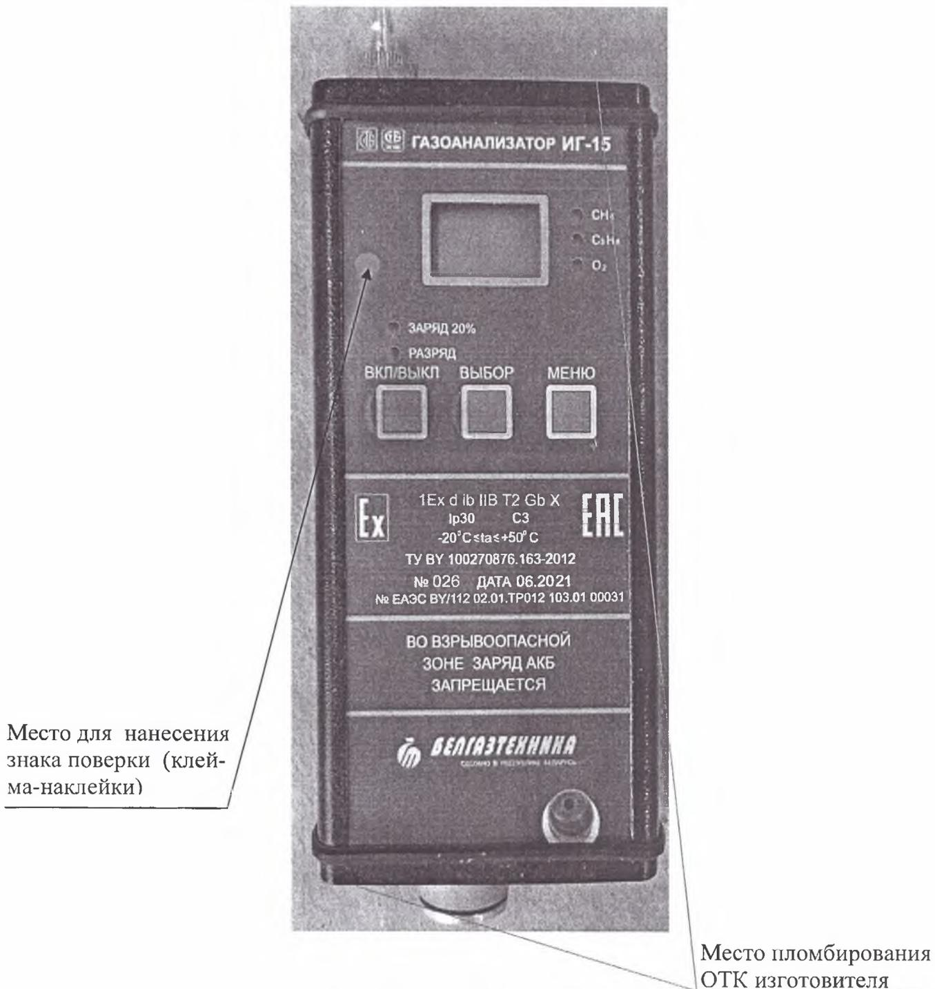
Рисунок 2 – Место для нанесения знака поверки (клейма-наклейки) и места пломбировки
